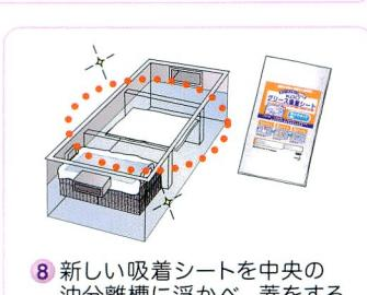
⑧ 新しい吸着シートを中央の油分離槽に浮かべ、蓋をする
