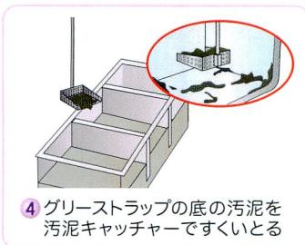
④ グリーストラップの底の汚泥を汚泥キャッチャーでくいとる
