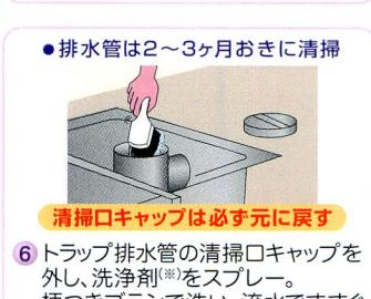
⑥ トランク排水管の清掃口キャップを外し、洗浄剤(※)をスプレー。
